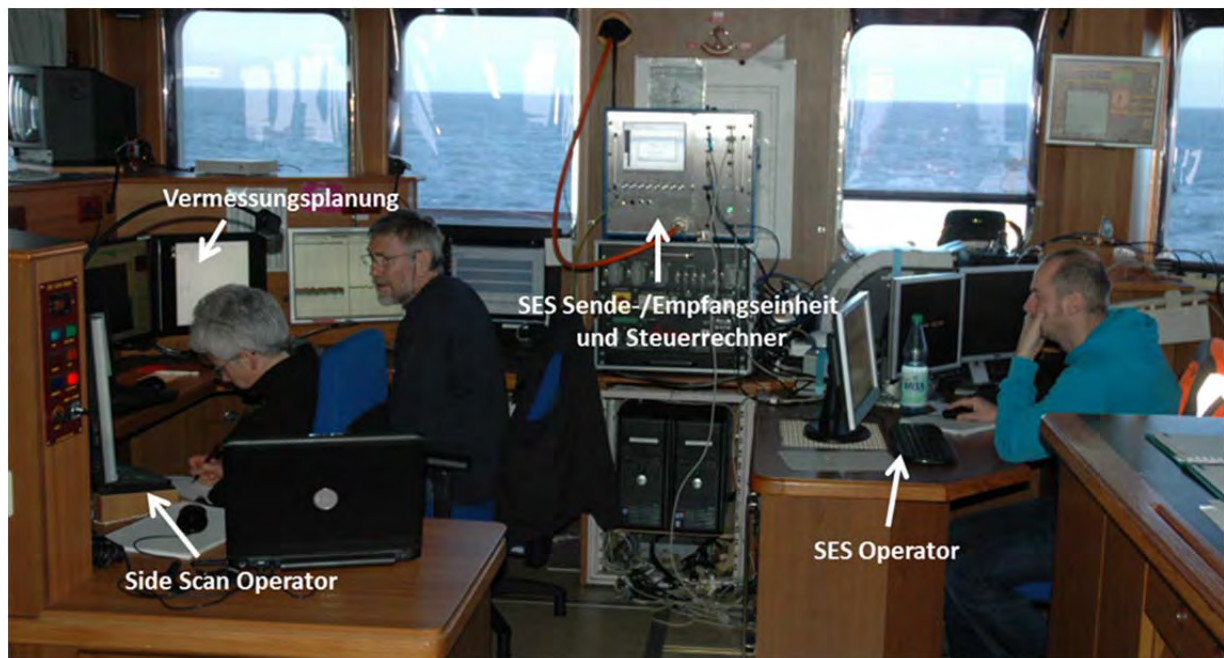
Abbildung 3: hydrographischer Arbeitsplatz an Bord des VWFS Wega
