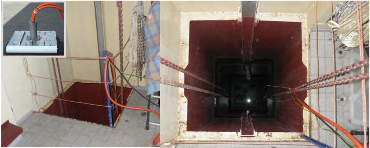
Abbildung 2: Hydrographischer Schacht auf VWFS Wega zur Aufnahme des SES - Schwingers
