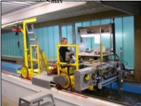
Bild 3: Messwagen der Umlaufrinne für Untersuchungen stationärer und instationärer Transportprozesse (Rechteckgerinne 1,5 m x 1,3 m, Untersuchungsstrecke 80 m, max. Strömung 1,5 m/s)
