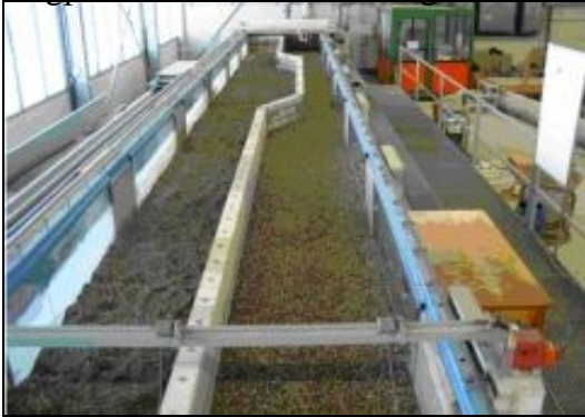
Bild 2a: Laborrinne mit einseitiger Einschnürung und Kiessohle (2 m x 20 m)
