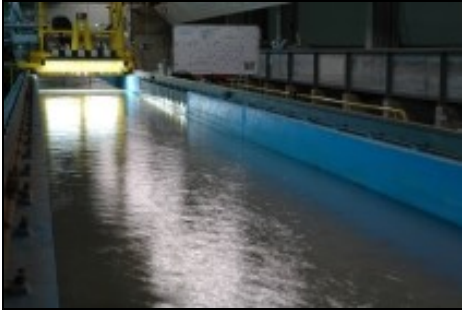
Bild 4: Strömungsuntersuchungen in der Umlaufrinne für Untersuchungen stationärer und instationärer Transportprozesse (Rechteckgerinne 1,5 m x 1,3 m, Untersuchungsstrecke 80 m, max. Strömung 1,5 m/s)
