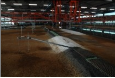
Bild 1: Flachwasserbecken mit Unterwassertopografie des Abschnittsmodells Unterelbe zur Minimierung langperiodischer schiffserzeugter Belastungen in Sportboothäfen an Seeschiffahrtsstraßen (Maßstab 1 : 40)
