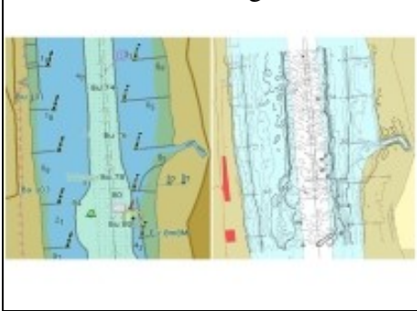
Bild 3: Aufbereitung von elektronischen Seekarten (ENC's) für Belange der WSV (links die offizielle ENC, rechts ENC mit hoch aufgelöster Unterwassertopografie)
