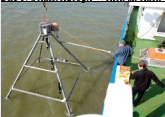
Bild 4: Ausbringen von Verankerungen in der Jade zur Erfassung sohnlicher Turbulenz- und Schwebstoffstrukturen
